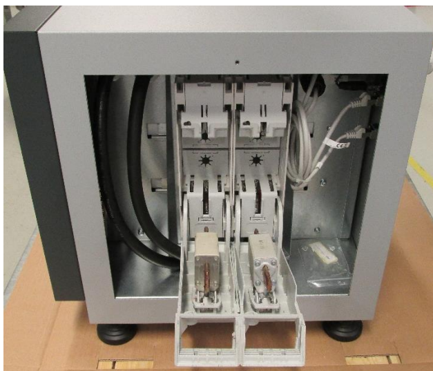
Obrázek 4-13: akumulátorový systém, boční pohled, izolátor napájení vytažený
