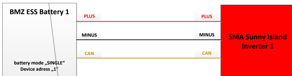
Obrázek 4-18 : Jednofázový provoz s jednou baterií ESS
